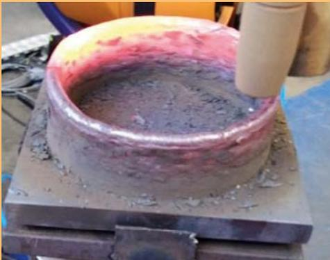
Additive Fertigung mittels Lichtbogen-schweißen, Foto: IEI, TU Clausthal.
